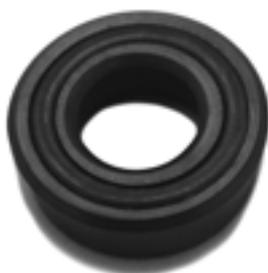
As Gaxetas Tipo B têm forma construtiva diferente das Gaxetas Tipo Standard, pois possui um chanfro no lábio, transferindo a área de contato para o centro da gaxeta, aumentando a sua estabilidade. Desta forma, recomenda-se o uso em cilindros com cursos maiores.
