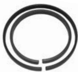
O Guia de Cilindro tem como função guiar o pistão e a haste em cilindros hidráulicos e pneumáticos, evitando o contato entre metais durante o movimento das peças do cilindro.
