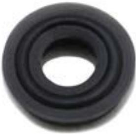
As Gaxetas Tipo Standard têm na sua forma construída, altura e secção iguais, sua aplicação principal é a vedação de êmbolos, devido a sua forma compacta. As Gaxetas Tipo Standard facilmente substituem a Tipo U e a Tipo V, com vantagem de vedação mais eficiente em baixa pressão e vida útil maior.
